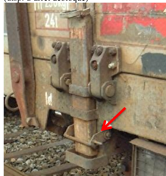
Support de haussette latérale abaissé de quelques cm (disp. d'arrêt débloqué)
