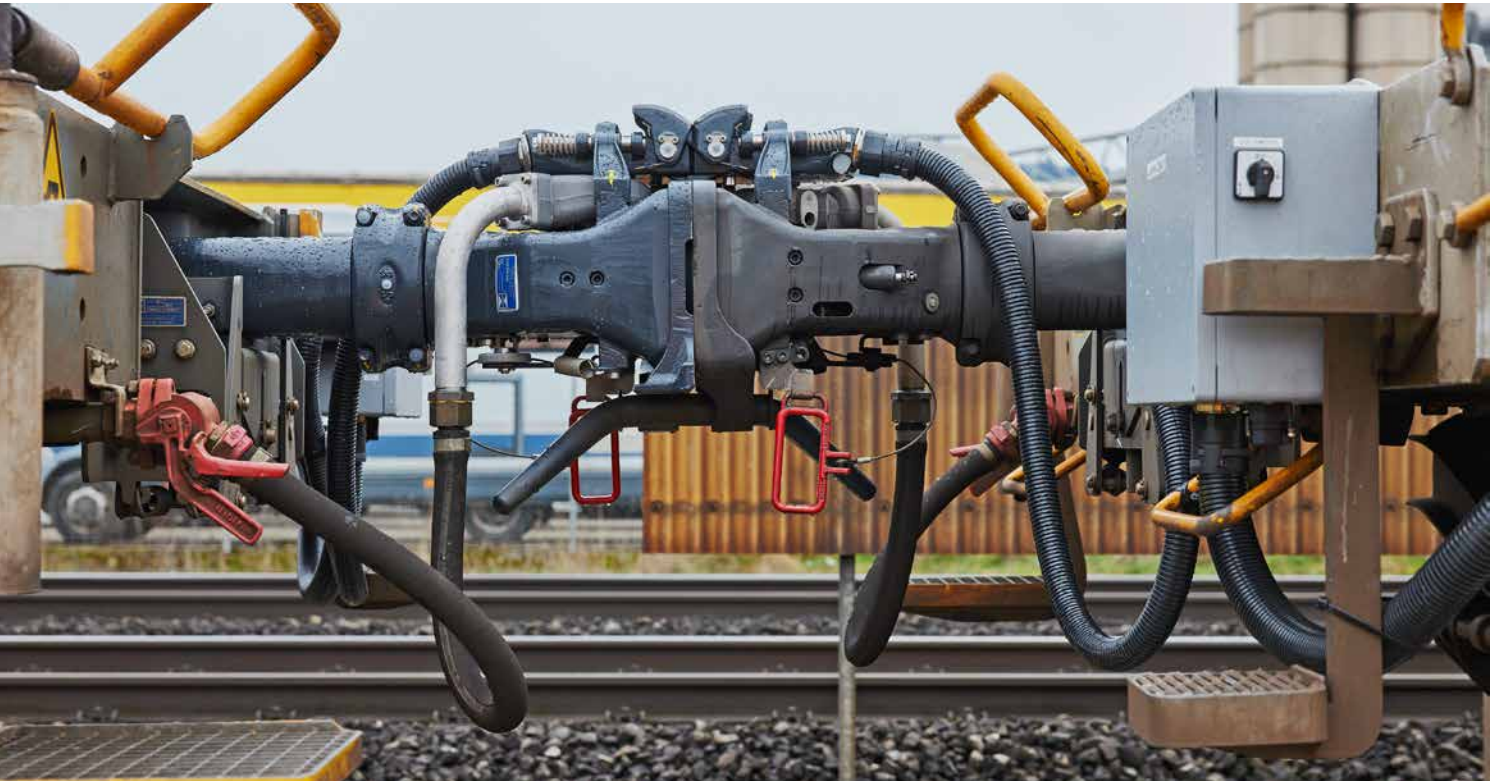
Die digitale automatische Kupplung verbindet die Wagen nicht nur mechanisch miteinander. Sie ermöglicht ausserdem die zentrale Speicherung von Daten zur Zugüberwachung und -sicherung.
