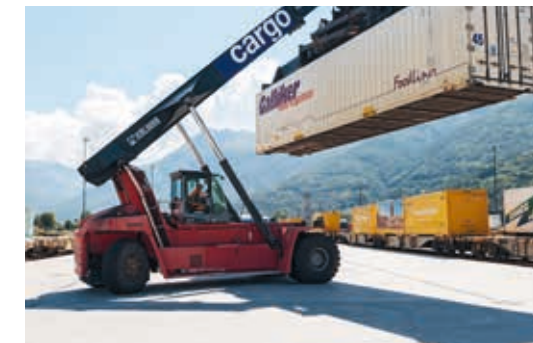
Fünfzig Tonnen kann der Reach-Stacker heben und senken.
