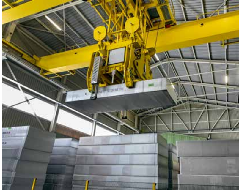
Aus solchen Aluminiumbarren, die per Bahn ins Novelis-Werk in Siders gebracht werden, entstehen dort durch Walzen dünne Aluminiumbänder.
