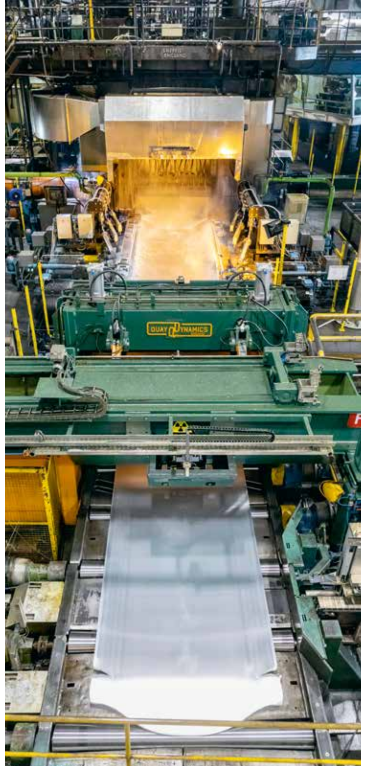
Die Walzstrasse bei Novelis: Durch wiederholtes Hin und Her wird aus dem dicken Aluminiumbarren ein dünnes Blechband.
