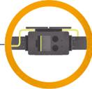
gons aux locomotives grâce au lent rapprochement des wagons. Le dételage s'effectue avec une simple poignée, par actionnement manuel d'un câble. Le nouveau système accélère la manœuvre et améliore la sécurité du personnel.
