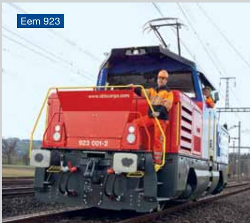
Le renouvellement complet des locs de manœuvre sera achevé l'année prochaine. Il n'y aura plus alors que 3 types de locs au lieu de 10: la nouvelle locomotive hybride Eem 923 sera la pièce maîtresse de la flotte. La loc diesel moderne Am 843 sera surtout employée pour les services de manœuvre et de livraison lourds, et le Tm 232 pour les services légers. Les coûts d'exploitation et de maintenance s'en trouveront
