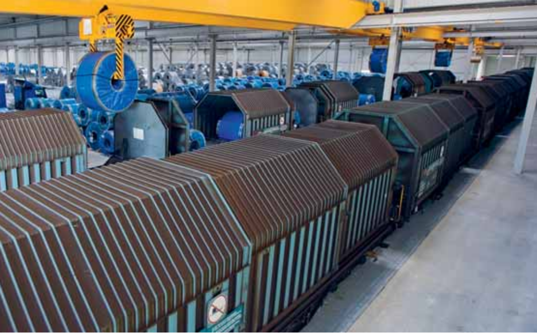
Nouvelle installation, capacités de transbordement accrues: bobines chargées dans des wagons Shimms.
