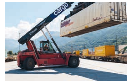
Le reach stacker peut monter ou descendre cinquante tonnes.
