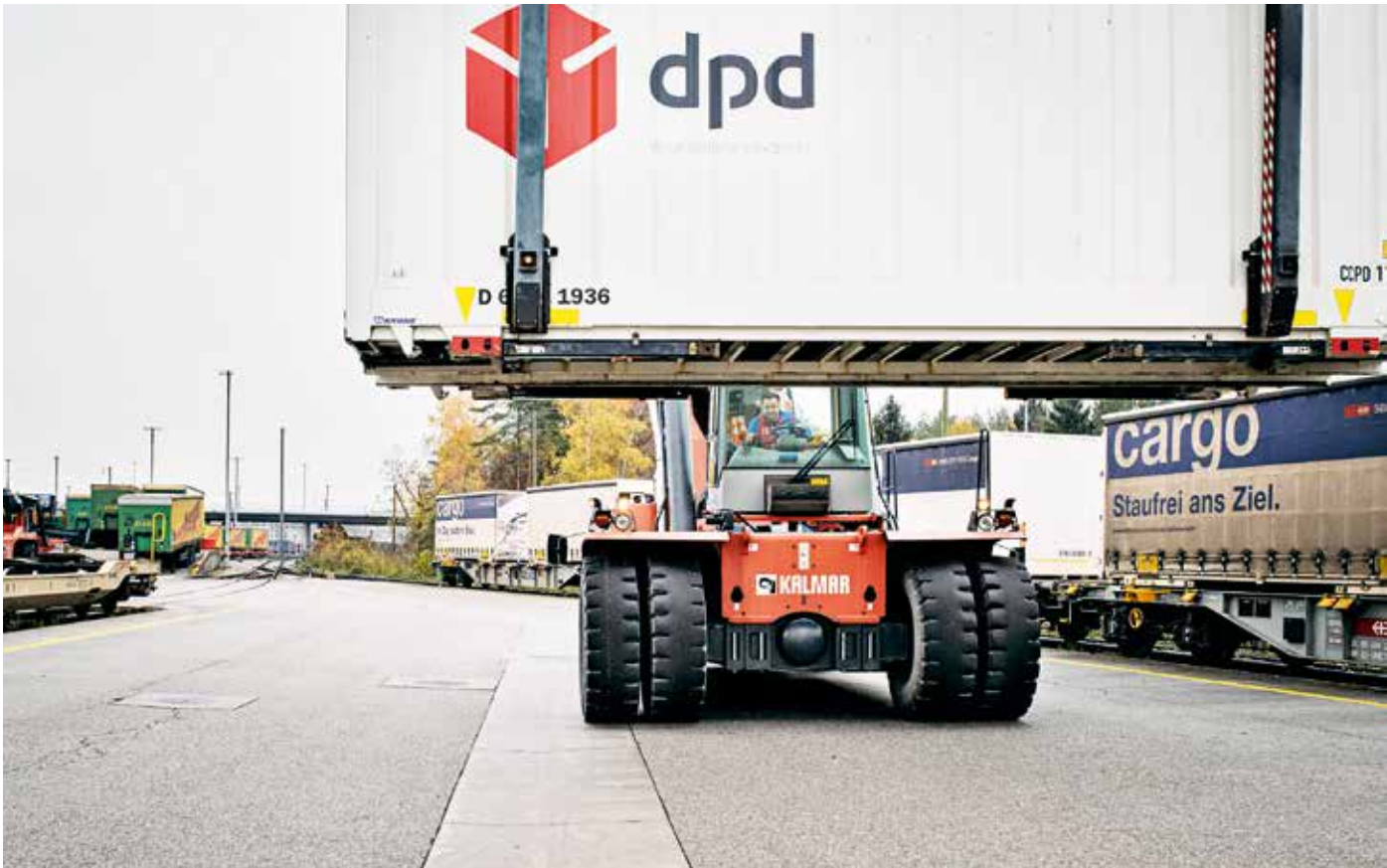
Le reach stacker permet de soulever des charges pouvant atteindre 50 tonnes.
