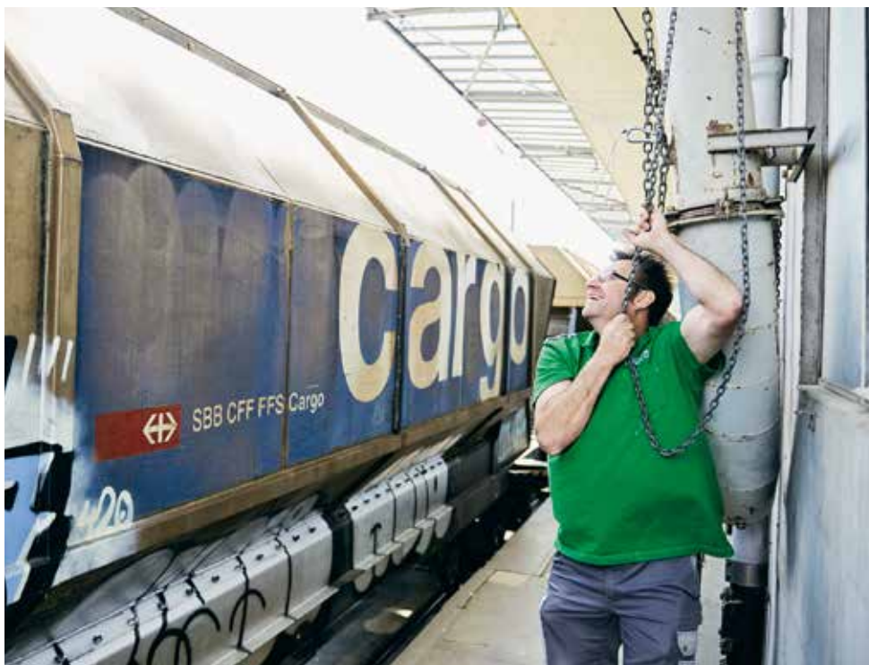
Du silo au rail: un wagon peut accueillir environ 60 tonnes de céréales, soit plus du double d'un camion.
