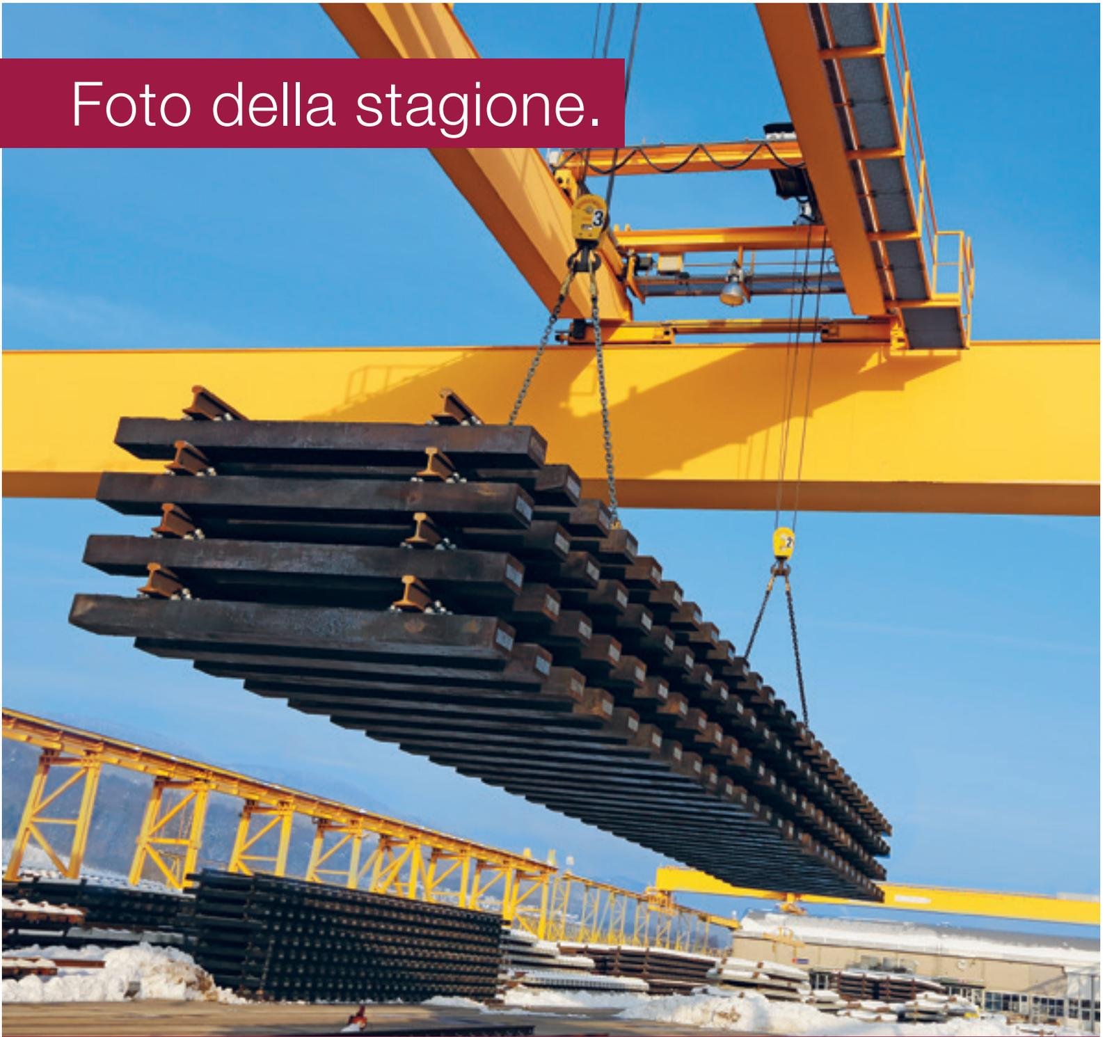
3000 chilometri misura la rete delle FFS. Quest'ultima è sottoposta a regolari lavori di manutenzione che, dato l'utilizzo intensivo della rete, vanno eseguiti il più velocemente possibile. Ecco perché binari e scambi sono montati nel Centro di tecnica ferroviaria (BTC) e poi trasportati direttamente a destinazione da SBB Cargo. Bernhard Lochmatter ha fotografato il BTC di Hägendorf presso Olten.
