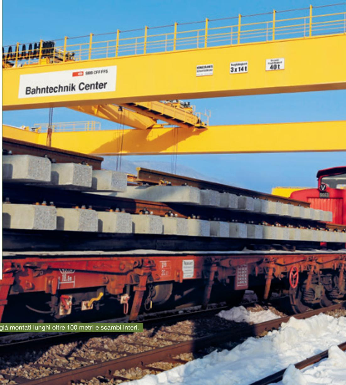
Una visione impressionante: sei carri pianale, ciascuno lungo 20 metri, allineati come perle di una collana formano un enorme ponte a bilico. Sopra si trova il prodotto più grande tra quelli trattati nel Centro di tecnica ferroviaria (BTC) delle FFS a Högendorf presso Olten: delle rotaie lunghe 108 metri. Circa 160 volte all'anno i treni blocco di SBB Cargo trasportano dalla
