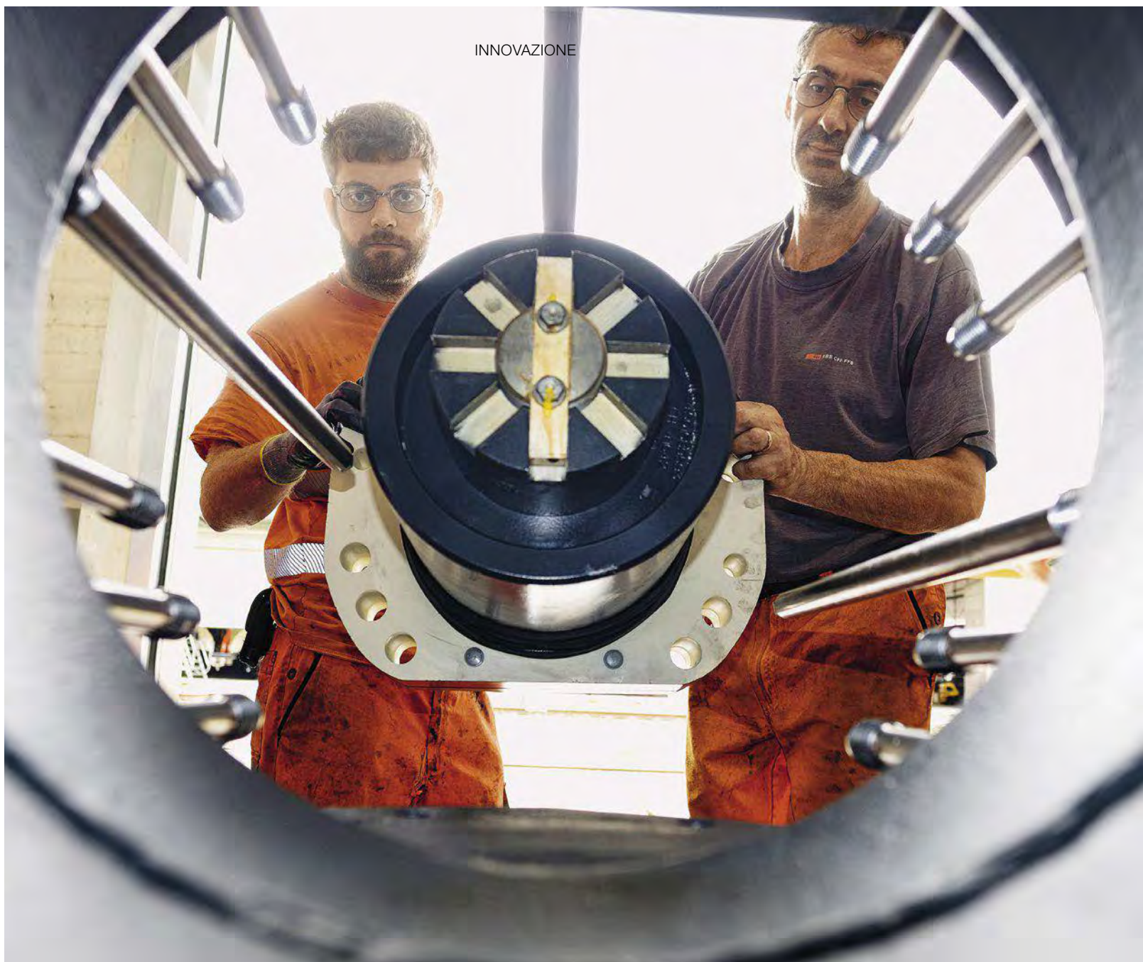
Uno sguardo dall'interno della locomotiva: due operai montano il nuovo accoppiamento ibrido.
