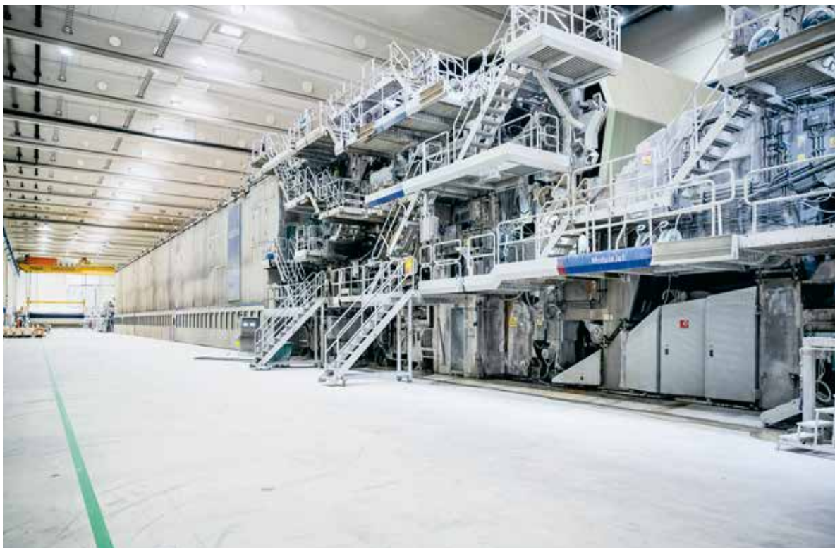
La macchina continua di Perlen è lunga 200 metri e alta 10 metri e produce carta da giornale. La Perlen Papier AG è l'ultima cartiera rimasta in Svizzera a produrre carta da giornale.
