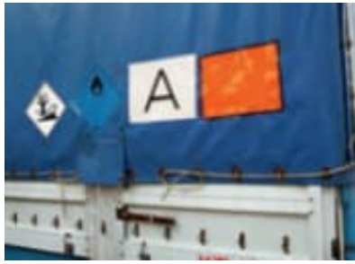
Sattelanhänger mit korrekter Abfall- und Gefahrgutkennzeichnung im Seeverkehr
