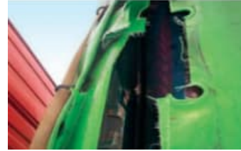
Gerissene Plane und defekte Ösen
