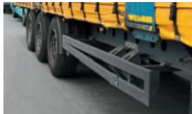
Verbogener seitlicher Unterfahrschutz
