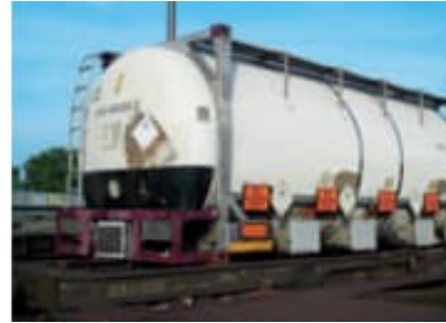
4-Kammer-Tankcontainer mit korrekter Gefahrgutkennzeichnung
