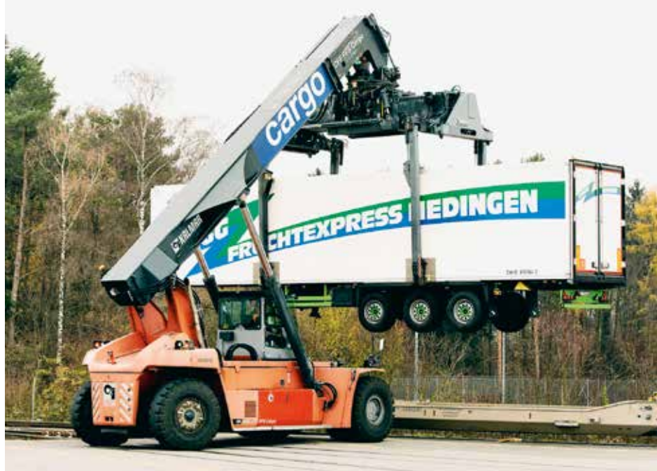
Nur mit einem Reachstacker kann man Container oder – wie hier – Sattelaufleger sowohl von oben als auch von unten heben.
