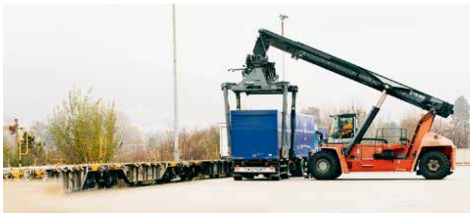
Nichts mit Automatisierung: Die Bedienung des Reachstackers ist Präzisionsarbeit. Da kann es auf wenige Zentimeter ankommen.
