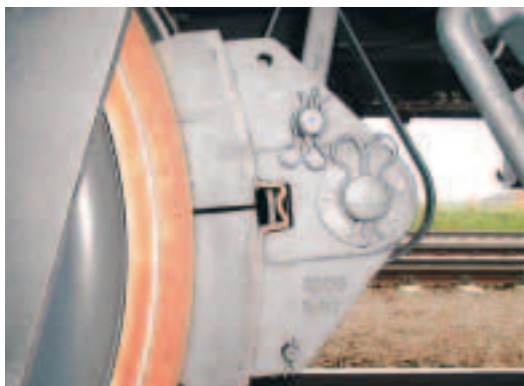
Une durée de vie plus longue: les sabots de frein en plastique.
