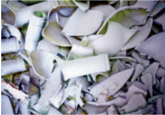
Film blanc laiteux: le verre usagé est recouvert de sable de silice, qui voltige sur le site, avant d'entamer son processus de recyclage.
