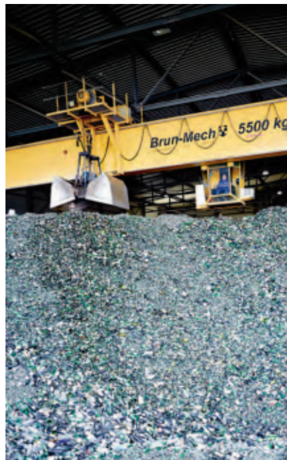
Hangar de déchargement du verre: dans la verrerie de St-Prex, bouteilles et verres usagés sont concassés à l'aide d'un pond roulant avec grappin.
