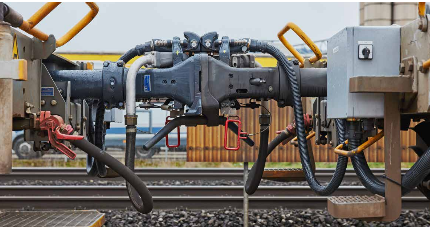
Avec l'attelage automatique numérique, les wagons ne sont pas reliés entre eux uniquement mécaniquement. Le DAC permet également de centraliser le stockage des données pour la surveillance et la sécurité des trains.
