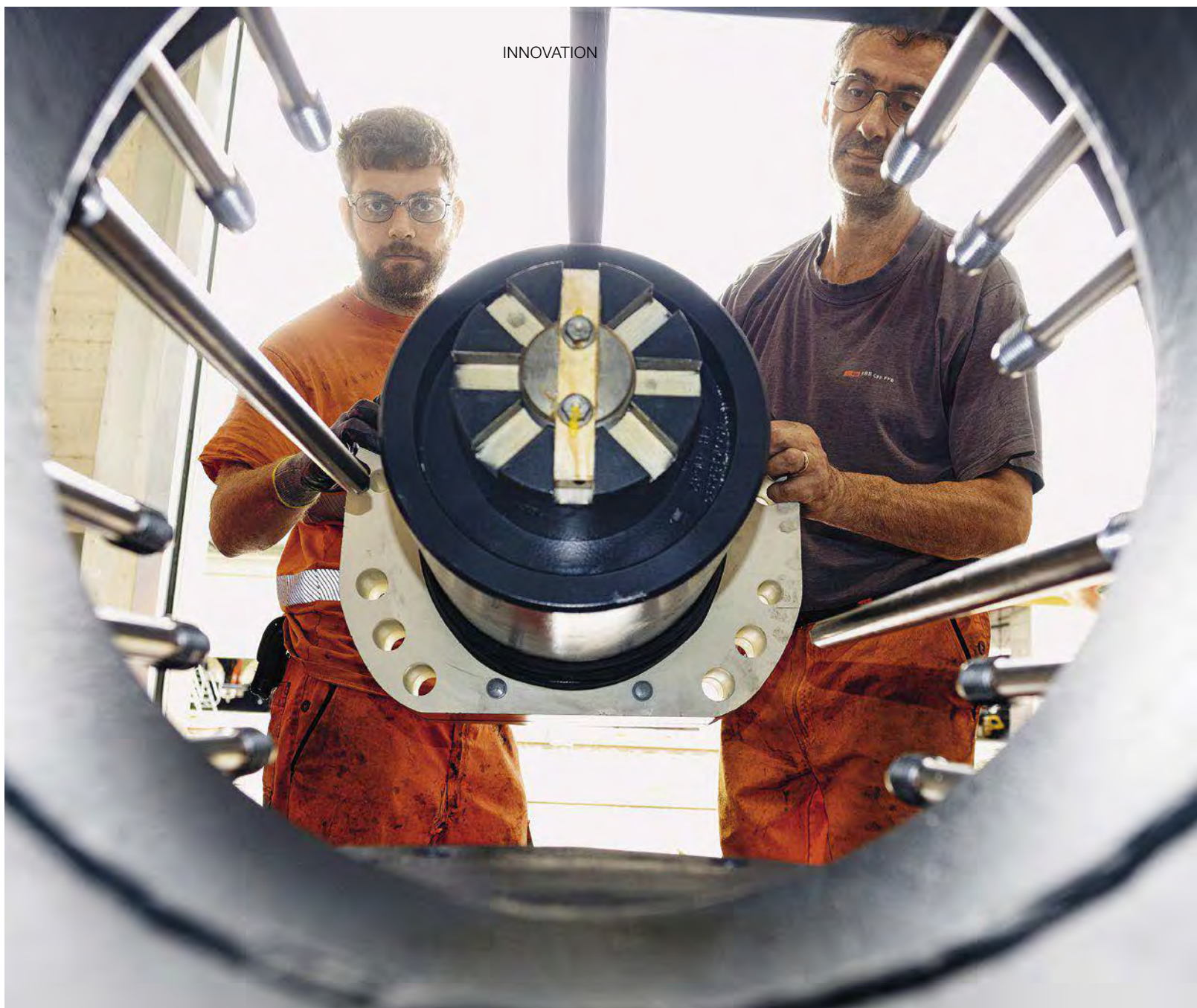
Le montage du nouvel attelage hybride par deux collaborateurs des ateliers, vu de l'intérieur de la locomotive.
