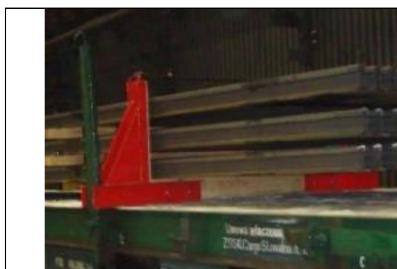
Telaio posizionato sul carro
