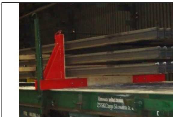
Telaio posizionato sul carro
