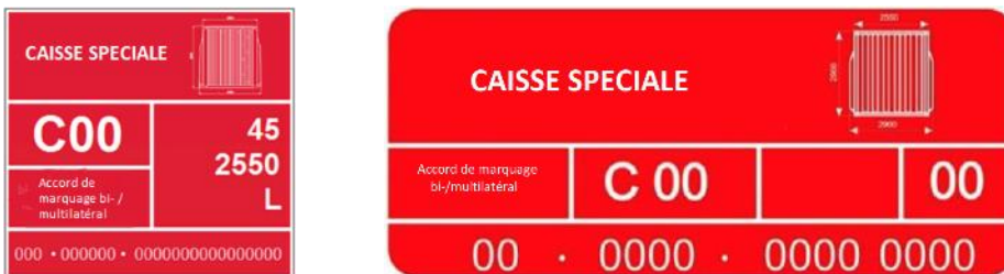
I dati sulla tavola comprendono il codice del profilo e la larghezza secondo UIC 596-6 / IRS 50596-6 nonché indicazioni sulla categoria di lunghezza e sul numero dell'accordo bi / multilaterale (Esempio di carico)
