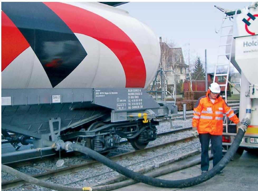
Trasbordo del cemento da un carro speciale Holcim al camion.
