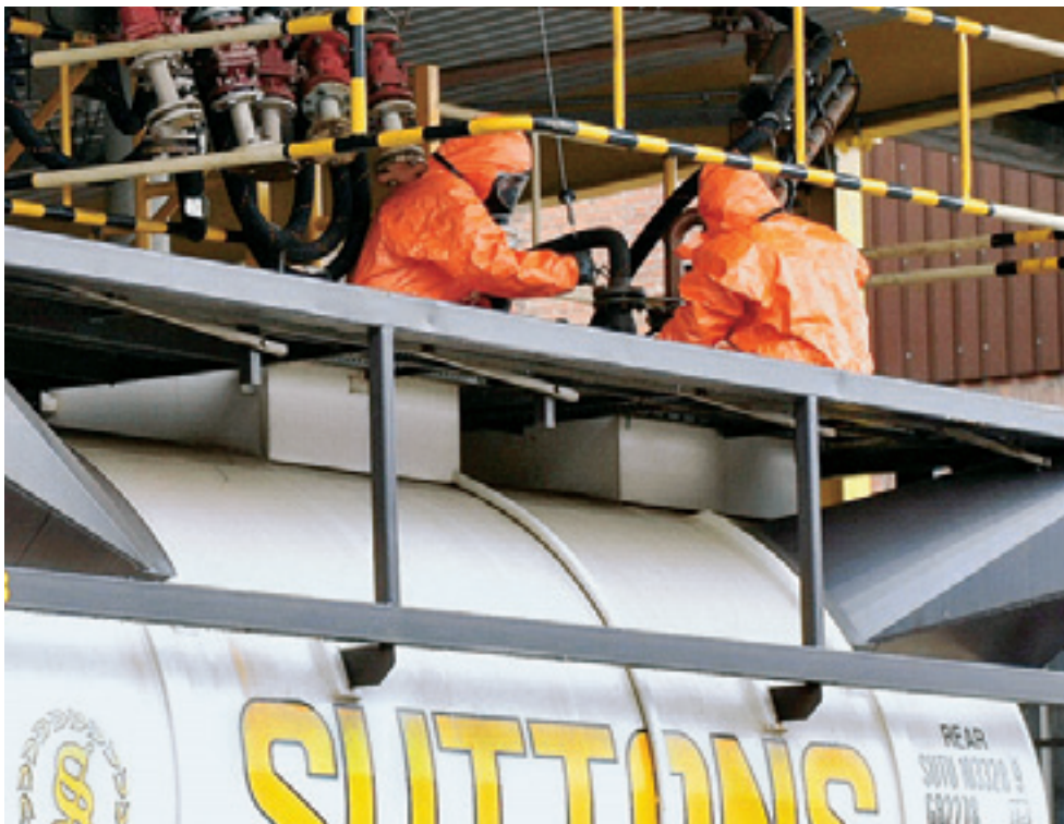
Operazione di carico di un container cisterna con solfato di dimetile a Pratteln nei pressi di Basilea.
