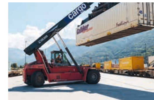
Il reach stacker è in grado di sollevare e abbassare cinquanta tonnellate.
